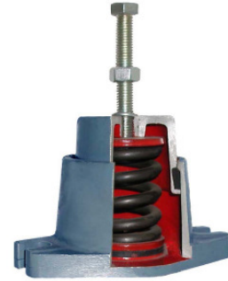
Feder-PHONOLATOR Typ A5/85 Gehäuse aus Leichtmetallguß, mit Höheneinstellvorrichtung und Körperschalldämmenlage, belastbar von 100 bis 165 kg, für Drehzahlen über 630 Upm.
