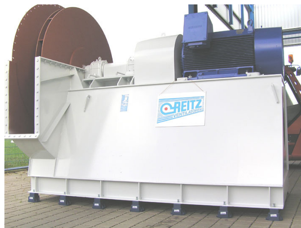
Abb. 10: Schwingungsisierte Aufstellung eines Ventilators, Gewicht ca. 12.000 kg, Drehzahl 1.500 Upm aufgestellt auf 14 Stück Feder-PHONOLATOREN Typ A8/89
